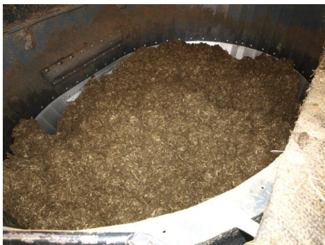
Ensileret halm-efterafgrøde blandes let ind i biogasanlægget. (Foto: Erik Fog, SEGES).
